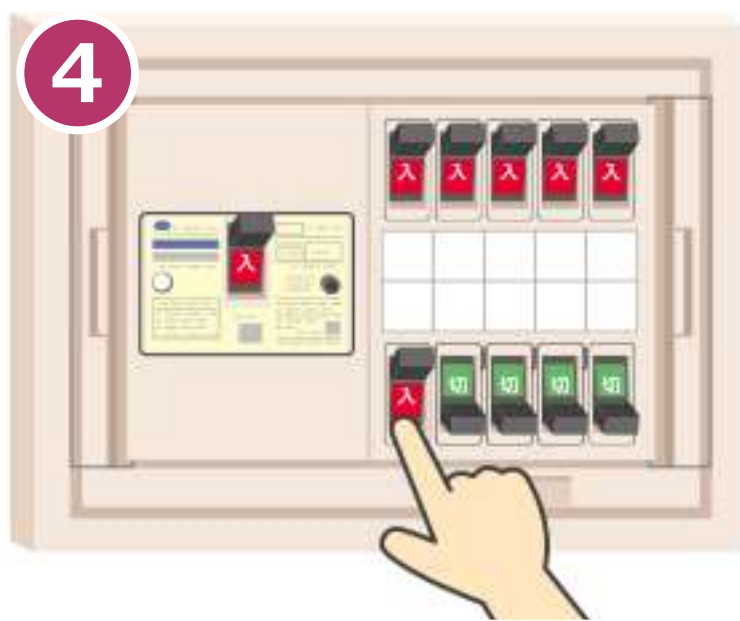
4 配線用遮断器のつまみをひとつずつ「入」にする
