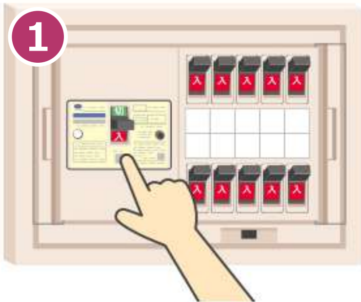
1 漏電遮断器のつまみが切れているのを確認する
