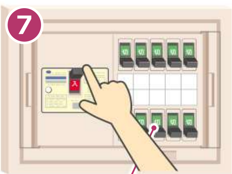
7 漏電している回路 漏電遮断器のつまみを下まで下げてから再び漏電遮断器を「入」にする
