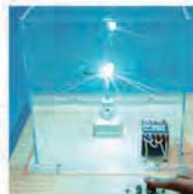
[短絡実験装置によるアークの発生実験]
