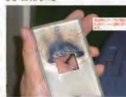
[事故例1] 天井裏の工事で照明器具を延長コードと一緒に繋ぐ際に、誤接続で1相が露出した状態で感電して作業員が死亡した事故例
