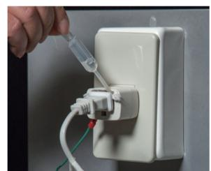
ホコリが湿気を含んだ状況を再現するために、手拭の切れ端にスポットで水分を含ませます。
