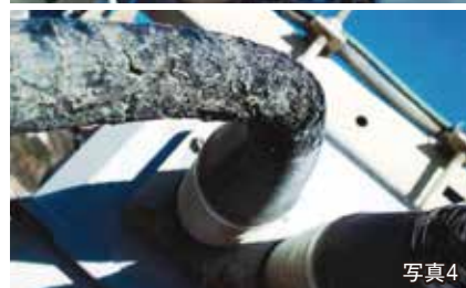
塩害によって亀裂が入ってしまった碍子(写真3)と、端末部のカバーが焼損しただれてしまったPASの負荷側ケーブル(写真4)
